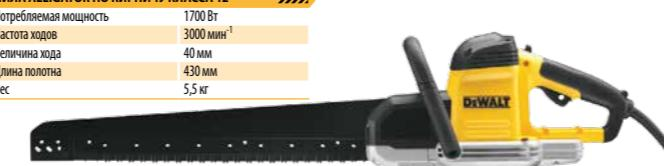
• Пила "Аллигатор" поставляется с твердосплавным двойным полотном 295 мм класса 12 идеально подходит для резания кирпича Класса 12 (Портерм)
